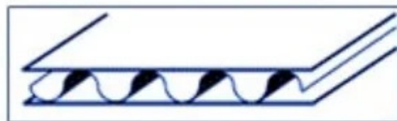
Onda Simples (Duplex) 2 faces lisas e uma face ondulada.
