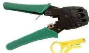
Alicate Para Crimpagem Conectores De Rede RJ45 RJ12 RJ11
