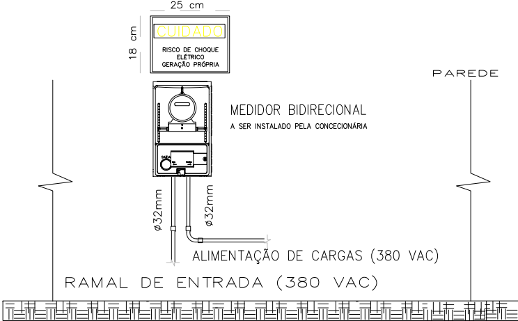
DETALHE XX – MEDIÇÃO E PLACA DE ADVERTÊNCIA
