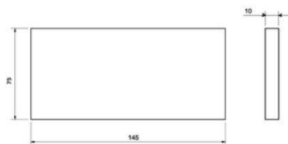
Figura 18 - Calço interno do nicho que apoia o terminal do mesário para todas as urnas, identificado como "B" na Foto 8 do Anexo I - II
