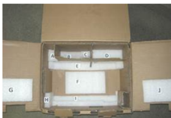
Foto 8 – Posicionamento dos calços de espuma de PE da urna
