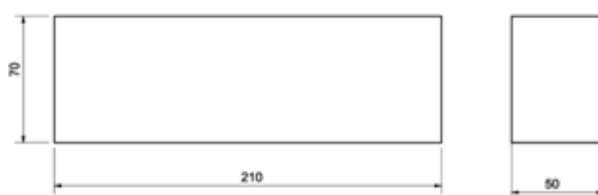
Figura 20 – Calço interno do nicho que apoia o cabo do terminal do mesário para todas as urnas, identificado como “D” na Foto 8 do Anexo I-II
