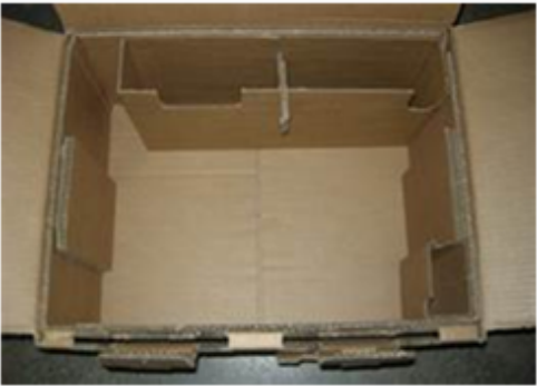
Foto 2 – Caixa sem o sistema de acolchoamento
