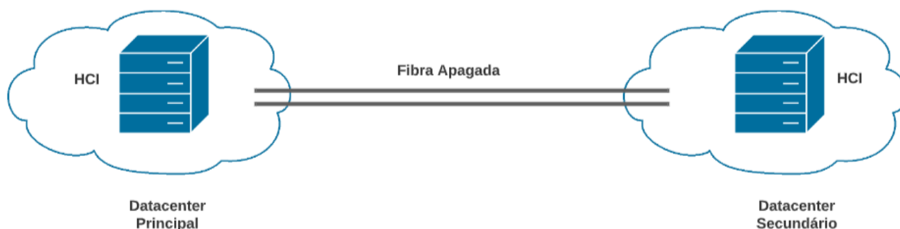
Figura 2: Proposta de comunicação digital entre os datacenters do TRE-PI
